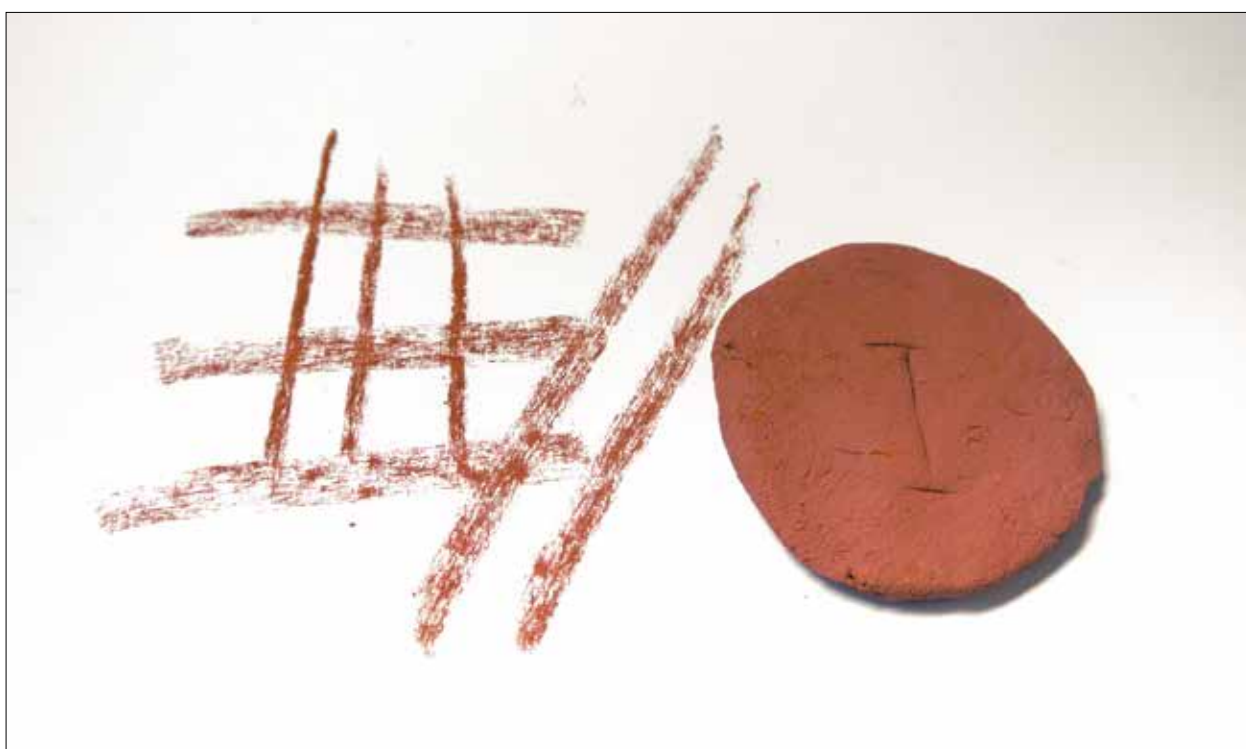
Figur 15. Den nya kritan bränns till 800°C och vid sidan ser man dess karaktäristiska linjer.
