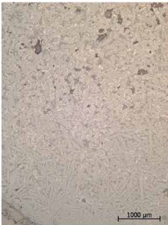
Fig. 11. P39075B i mikroskop. Fotot ger en representativ bild av hur slaggen ser ut. Den domineras av olivinkristaller och en glasfas. Wüstit förekommer i hela slaggen, men mestadels i mindre mängd. Kornstorleken ökar från botten och uppåt. Foto: Lena Grandin.
