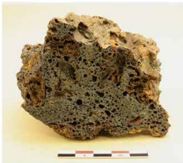
Fig. 2. Slagg i tvärsnitt. F157/P38136. Foto: Mia Englund.
